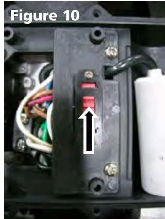
Pour passer au fonctionnement à 230 volts, faire glisser le commutateur de tension à la position « 230 » volts
